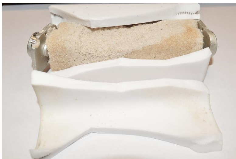
Рисунок 8. Вид предохранителей под керамическим корпусом. Образцы FRZ (слева) и Bussmann (справа).
