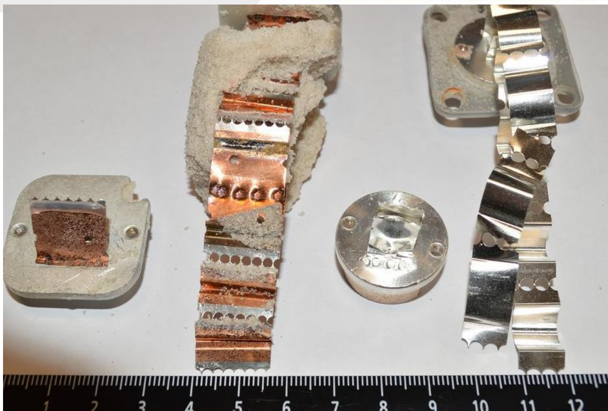
Рисунок 5. Внутреннее исполнение образцов предохранителей FRZ (слева) и Bussmann (справа).
