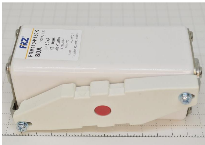
Рисунок 2. Измерение размеров длины, ширины, высоты образца предохранителя FRZ.
