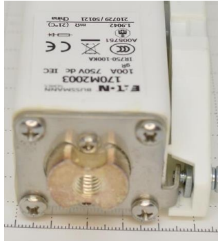
Рисунок 3. Измерение размеров длины, ширины, высоты образца предохранителя Bussmann.
