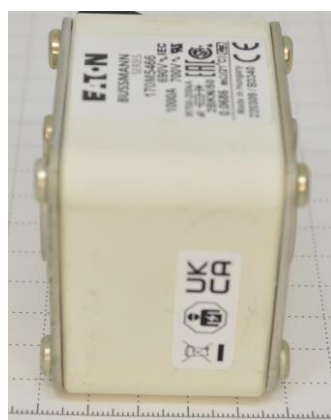
Рисунок 2. Измерение размеров длины, ширины, высоты образца предохранителя FRZ.
