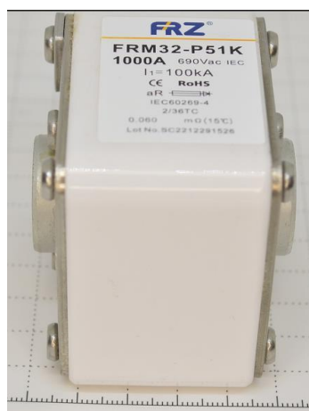
Рисунок 2. Измерение размеров длины, ширины, высоты образца предохранителя FRZ.
