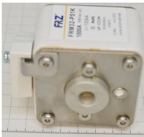
Рисунок 2. Измерение размеров длины, ширины, высоты образца предохранителя FRZ.
