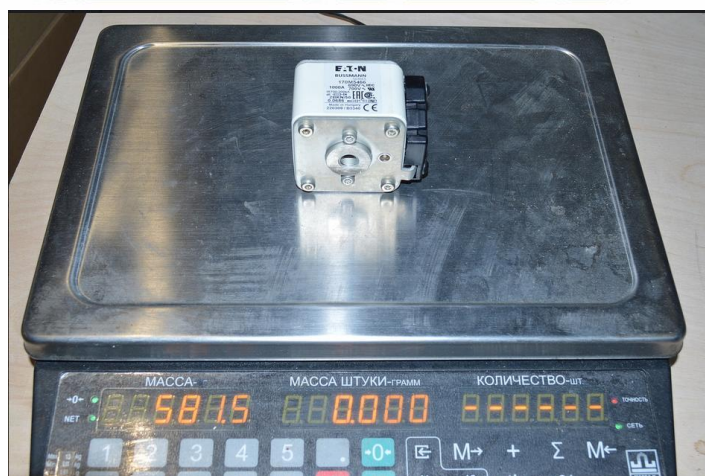
Рисунок 1. Значения предохранителей на весах (слева образец FRZ, справа EATON Bussmann)
