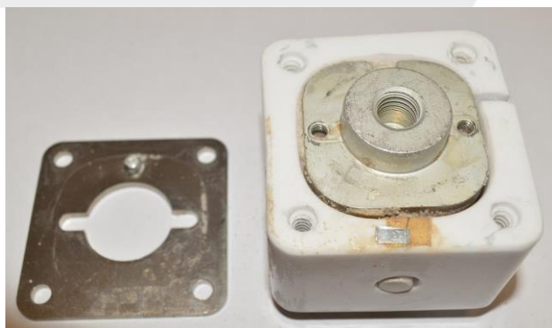
Рисунок 7. Вид предохранителей после демонтажа торцевых пластин. Образцы FRZ (слева) и Bussmann (справа).
