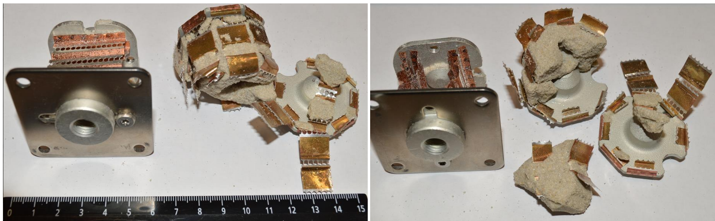
Рисунок 5. Внутреннее исполнение образцов предохранителей FRZ (слева) и Bussmann (справа).
