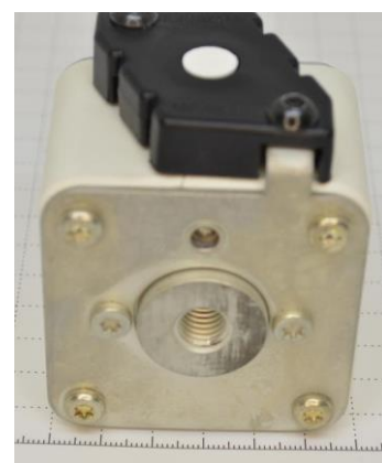
Рисунок 2. Измерение размеров длины, ширины, высоты образца предохранителя FRZ.
