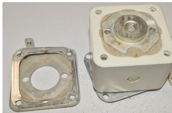
Рисунок 7. Вид предохранителей после демонтажа торцевых пластин. Образцы FRZ (слева) и Bussmann (справа).
